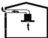
*Fig. 4: Scarico d'aria senza filtro a carbone*
